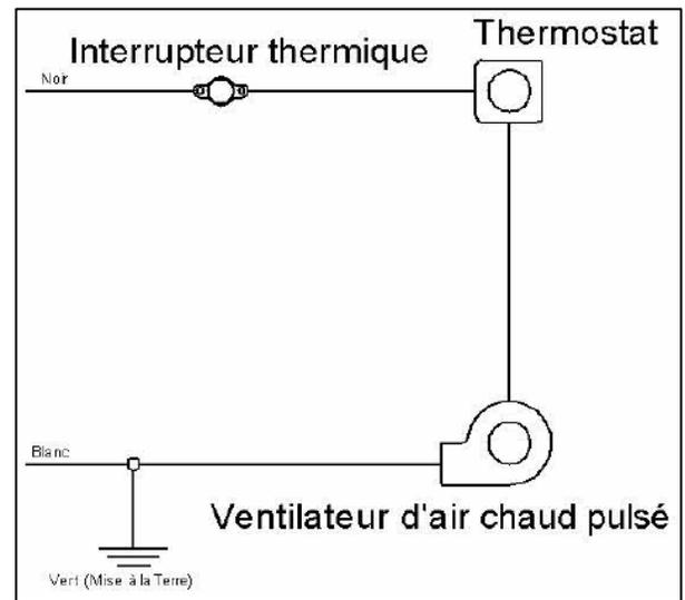
Illustration 4-2 : Diagramme électrique du système d'air chaud pulsé
