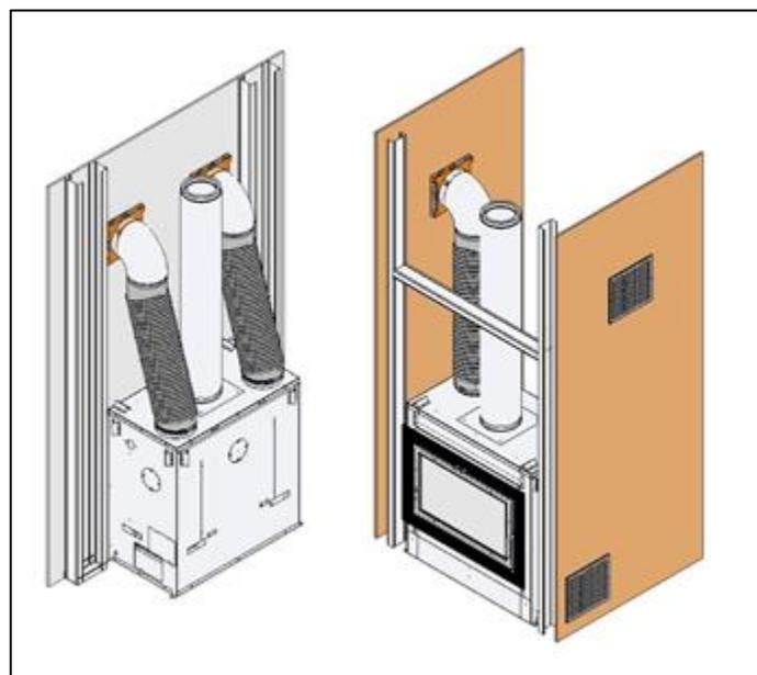
Illustration 3-22: Installation des sorties d'air chaud par gravité
