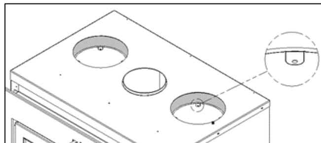
Illustration 3-20 : Languettes à l'intérieur des ouvertures de 8 pouces
