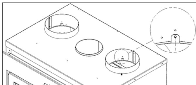
Illustration 3-21 : Installation des adaptateurs de conduit de 8 pouces
