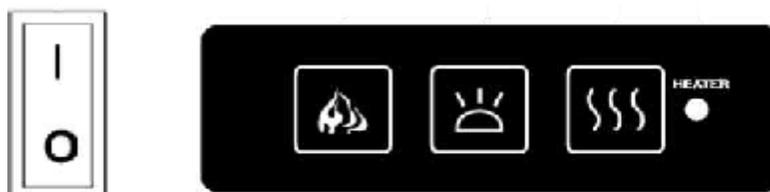
1. Lorsque l'interrupteur ON / OFF est en position O, le foyer est éteint.
