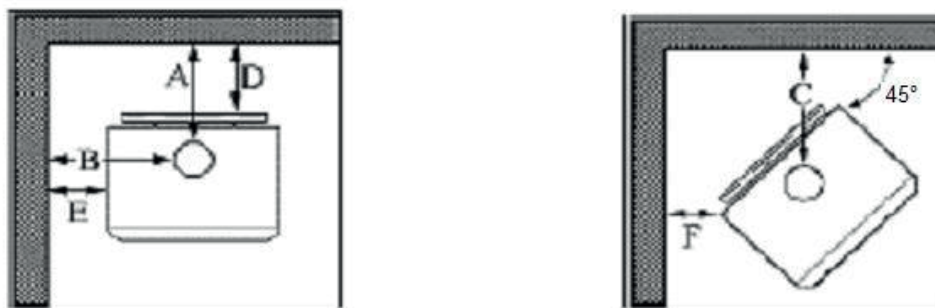
Figure 4. a) Installation parallèle, b) Installation en angle
