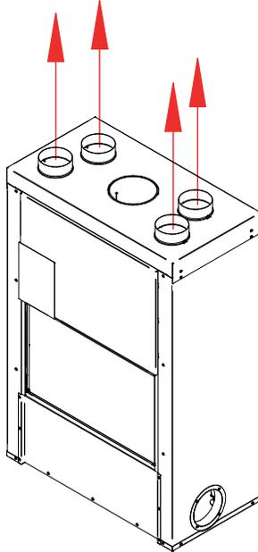
La distance minimale entre les grilles d'air de convection et le plafond ou tout autre surface combustible est de 6.5 pouces. Utilisez seulement des matériaux non combustibles sur 6.5" autour des grilles d'air de convection.
