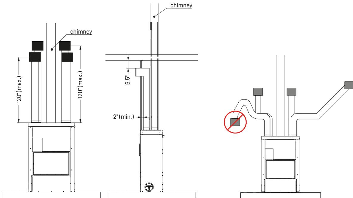
Utiliser un conduit flexible en aluminium avec 1" d'isolation.
