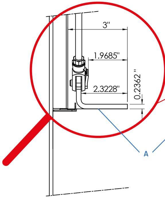
Le rebord intégré (A) en forme de « L » peut recevoir la finition non-combustible (B) de votre choix. Jusqu'à 300 lbs de matériel. Il peut être mis à niveau en ajustant les longues tiges (C) de chaque côté du foyer.
