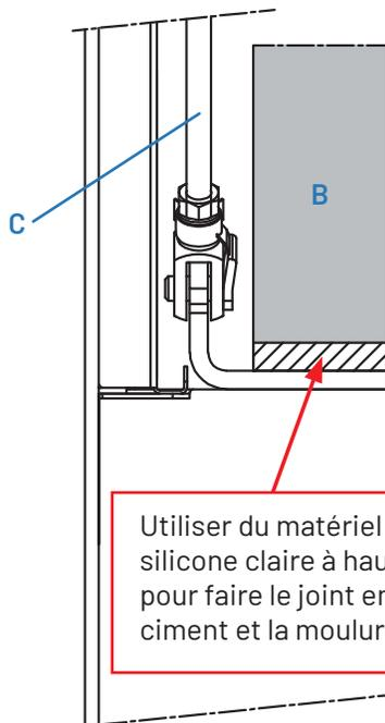
Utiliser du matériel flexible tel du silicone claire à haute température pour faire le joint entre la feuille de ciment et la moulure en acier.
