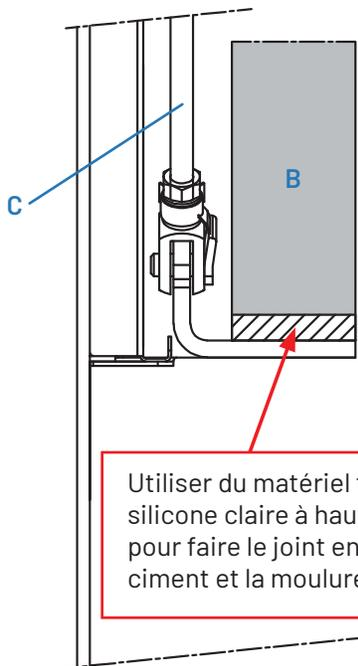
Utiliser du matériel flexible tel du silicone claire à haute température pour faire le joint entre la feuille de ciment et la moulure en acier.
