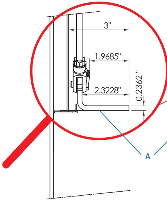
Le rebord intégré (A) en forme de « L » peut recevoir la finition non-combustible (B) de votre choix. Jusqu'à 300 lbs de matériel. Il peut être mis à niveau en ajustant les longues tiges (C) de chaque côtés du foyer.
