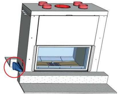
Raccord 'Rectangulaire à rond Ø 6" pour entrée d'air de combustion (#1047515)
