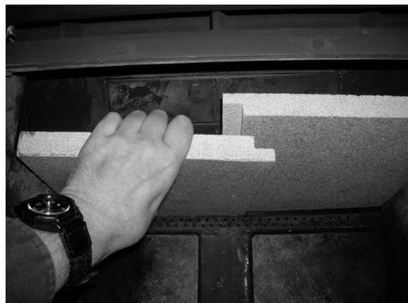
Figure 16: Enlèvement et Remplacement du Déflecteur pour Inspection
