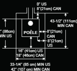
Quand le poêle est installé sur un plancher combustible, une protection de plancher non combustible doit être installée pour couvrir la surface sous le poêle. Elle doit dépasser d'au moins 16" (41cm) [18" (46cm) CAN] le devant du poêle, et 8" (21cm) au-delà du dos et des côtés du poêle [côté du poêle en CAN], et déborder de 2" (5 cm) de chaque côté du tuyau de raccordement de la cheminée.
