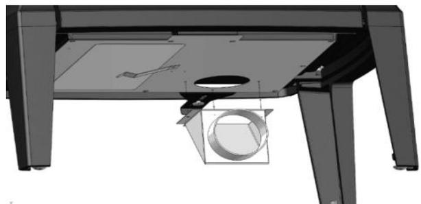
Figure 7 – Kit de Prise d'Air Extérieur
