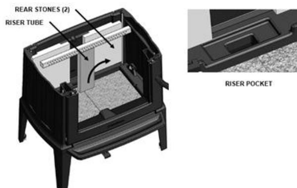
Figure 19 - ENLÈVEMENT DU TUBE ET DES PIERRES ARRIÈRES
