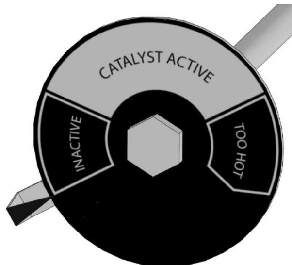
Figure 14 – Thermomètre du Catalyseur
