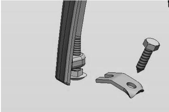
Figure 8 – Fixation du Poêle au Plancher
