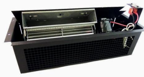
Le ventilateur de convection est activée par la chaleur et fonctionne à vitesse variable. Le ventilateur est inclus avec l'encastrable à bois 19i. Il est optionnel sur les poêles à bois 15 & 19.
