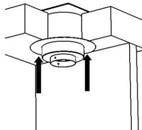
La plaque de finition cache plafond donnera à la cheminée un fini haut de gamme. Elle couvre l'espace entre le support rond et le plafond. Environ 7,5 pouces autour de la boîte de support. Si le plafond forme un angle de 90° avec la cheminée ou a une inclinaison de moins de 5°, utilisez la **plaque de finition cache plafond en 1 morceau**. Si l'inclinaison est plus importante, choisissez l'une des versions de **plaque de finition en deux pièces** (voir ci-dessous).
