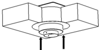
3. Pour les hauteurs sous plafond supérieures, installez les prolongations sur le support de fixation.
