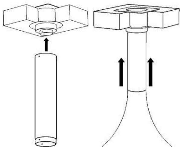
Fixation des prolongations sur la pièce de fixation:
