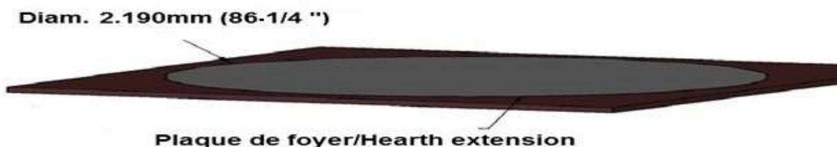
Dans le cas de l'installation d'une EVA 992 convertie avec un brûleur gaz, la plaque de foyer n'est pas nécessaire.
