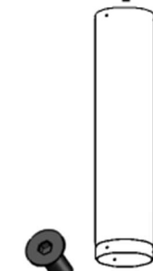
Fixation de la ZELIA908 - 3 vis TF M8x20
